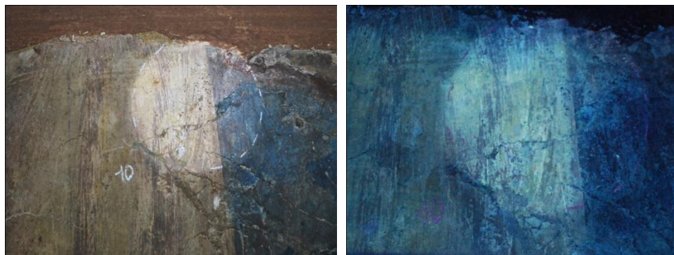
Foto 15-16: Prova di pulitura fotografata a luce naturale e a luce UV, si noti la differente fluorescenza della parte pulita rispetto al resto.
